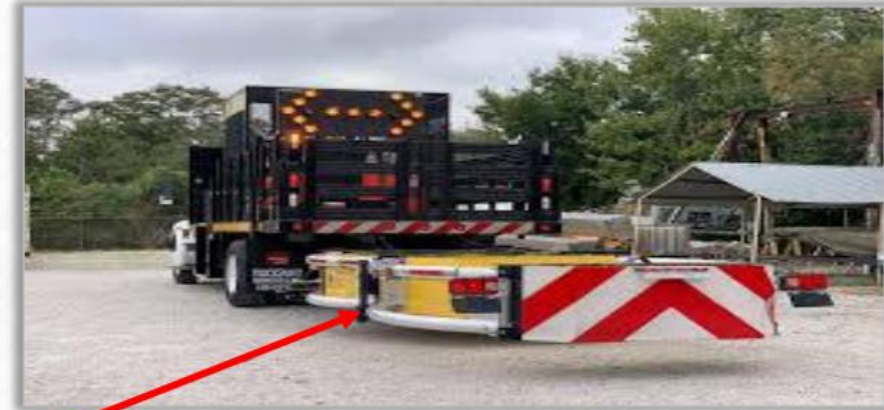
صورة توضح المركبة المزودة بجهاز ماص للصدمات ( TMA )
